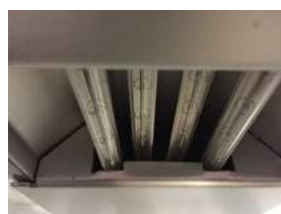
K-NIR Anlage für das sekundenschnelle Trocknen von Metall-Panels für Haushalts-Herde.
