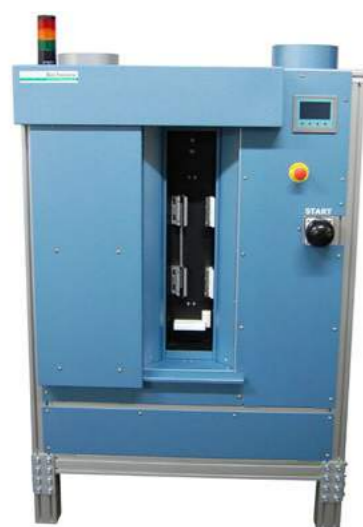
K-NIR Anlage für das sekundenschnelle Trocknen von Metall-Panels für Haushalts-Herde.
