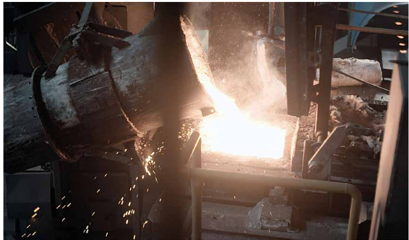
Einfüllen von Gusseisen mit Kugelgraphit in eine Vergießeinrichtung in der MAT Gießerei in Neunkirchen. Zur MAT Foundry Group gehören weltweit sieben Gießereien.
