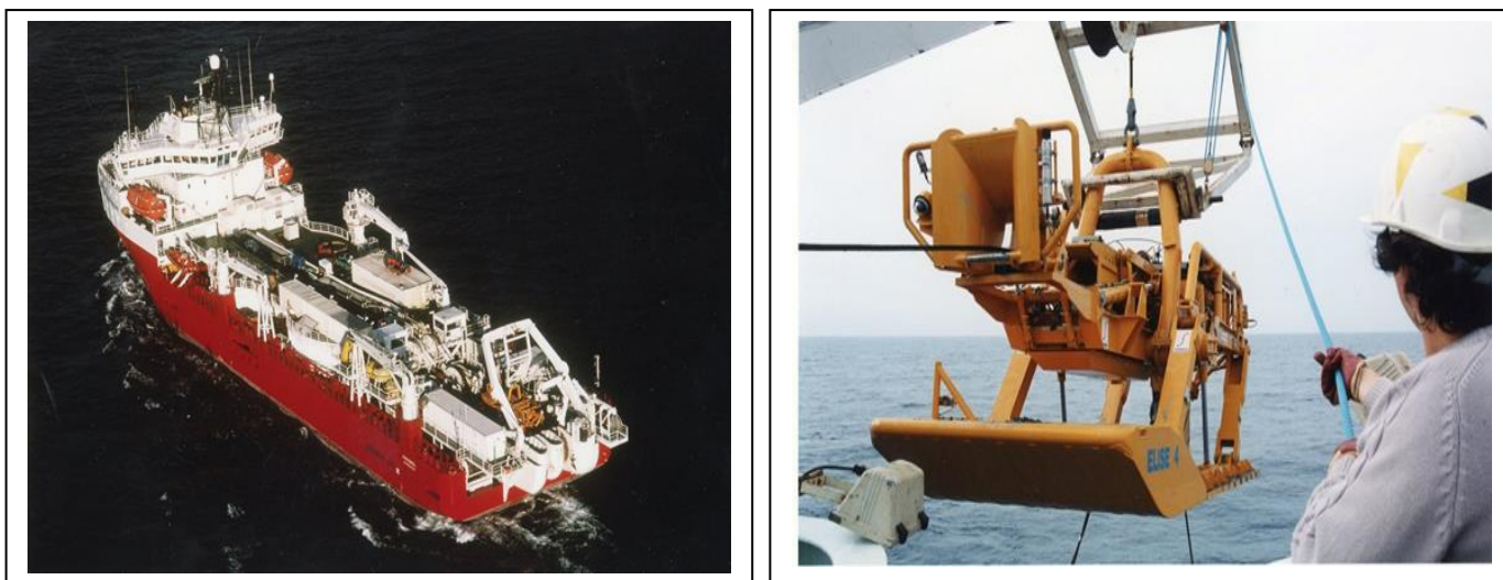
17 & 18 – Le NC FRESNEL (à gauche) et les charrues du type ELISE 3, 4 et 5 (à droite)
