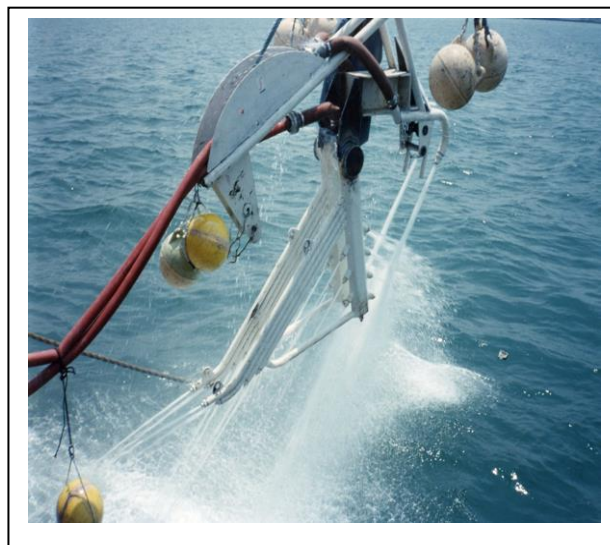
15 & 16 – Le chantier de Djakarta (Sea-Me-We 2) débuta par une surprise lorsque la nature du sol ne supporta pas le CASTOR 2. Ci-dessus, la barge support hollandaise (SMIT), à gauche et l’outil SCAT en essais à droite.
