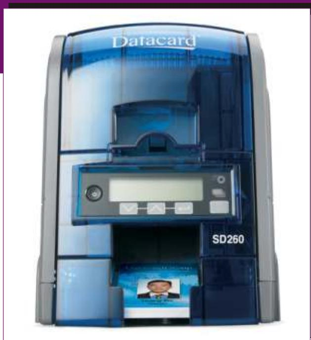
Impresora de tarjetas a 1 cara, color y monocromo de alta velocidad con tecnología de sublimación color y thermal transfer, resolución de impresión de 300x300 dpi, con conectividad USB y Ethernet con distintas opciones de codificación de tarjetas magnéticas y smart card.
