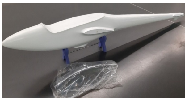
Masstab 1:3, Spannweite 4,5m bis 5m, Rumpflänge, 1,9m, Profil E203
