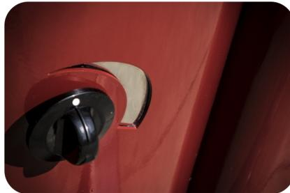
L'air secondaire est ajusté à la porte principale de la chambre de combustion.
