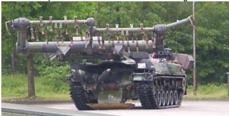
Minenräumpanzer Keiler dienen der schnellen Minenräumung im Gefecht
