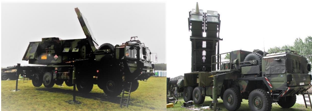
Eine Patriot-Feuereinheit verfügt u.a. über ein Mehrzweckradar und sechs Startfahrzeuge.
