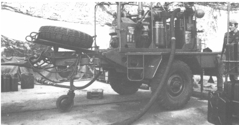
Pumpen für den Betriebsstoffumschlag
