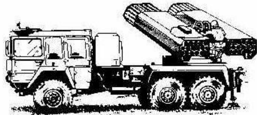
Leichtes Artillerieraketensystem in Divisions- Artillerie ab 1970, max.Schussweite 14 km
