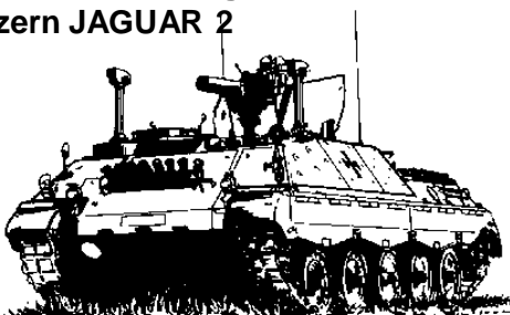
Ümbau zu Raketenjagdpanzer JAGUAR 2 mit TOW
