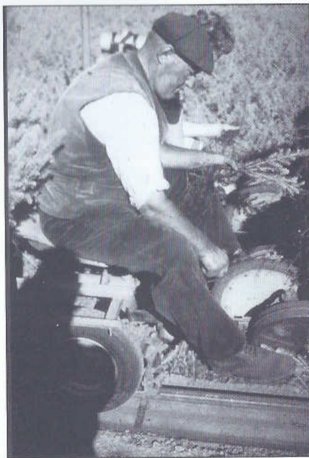
Prinzip der Pflanzmaschine: Die Pflanze wird – Wurzel nach oben – von zwei schräg zueinander stehenden Scheiben gedreht, in der Erde freigegeben und von einer schräg stehenden Rolle angedrückt.
