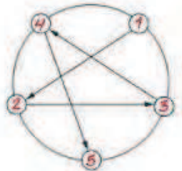
Beispiel: Radbolzen kreuzweise anziehen
