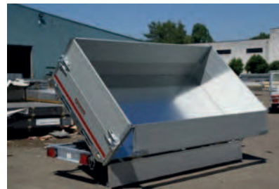
Abb. Oben scharnierverschlossene Bordwände
