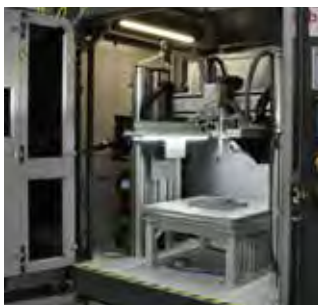
Versuchsanlage für den lichtbogenbasierten 3D-Druck von großvolumigen Bauteilen (links), Bauprozess (Mitte) und gedruckte Probe aus TiAl6V4 (rechts: Masse: 2,8 kg, Schweißzeit: 60 min).
