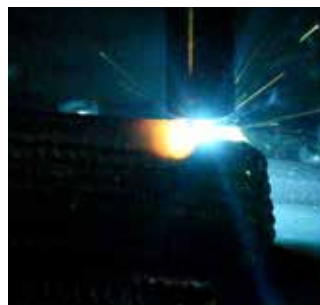
Versuchsanlage für den lichtbogenbasierten 3D-Druck von großvolumigen Bauteilen (links), Bauprozess (Mitte) und gedruckte Probe aus TiAl6V4 (rechts: Masse: 2,8 kg, Schweißzeit: 60 min).
