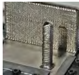
Versuchsanlage für den lichtbogenbasierten 3D-Druck von großvolumigen Bauteilen (links), Bauprozess (Mitte) und gedruckte Probe aus TiAl6V4 (rechts: Masse: 2,8 kg, Schweißzeit: 60 min).
