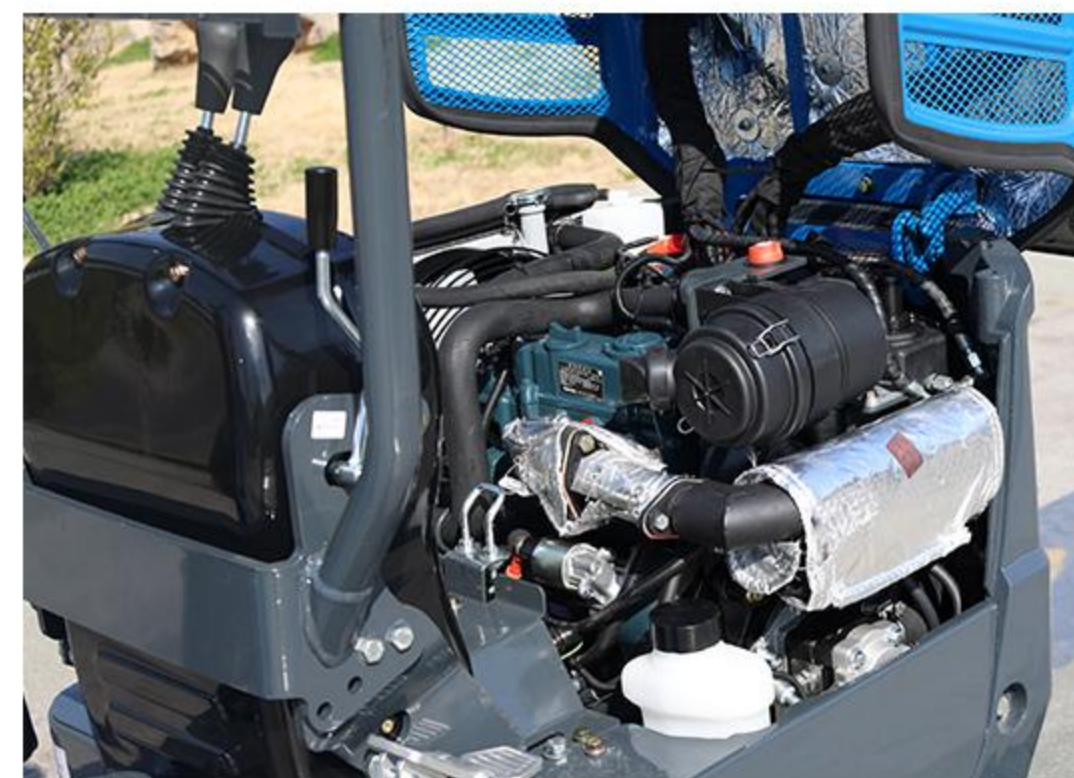
5 Vollständig öffnebare Motorhaube Die voll geöffnete Motorhaube öffnet sich weit nach hinten und erleichtert die Durchführung täglicher Inspektionen und Ersatzteile rund um den Motor und das Kraftstoffsystem.
