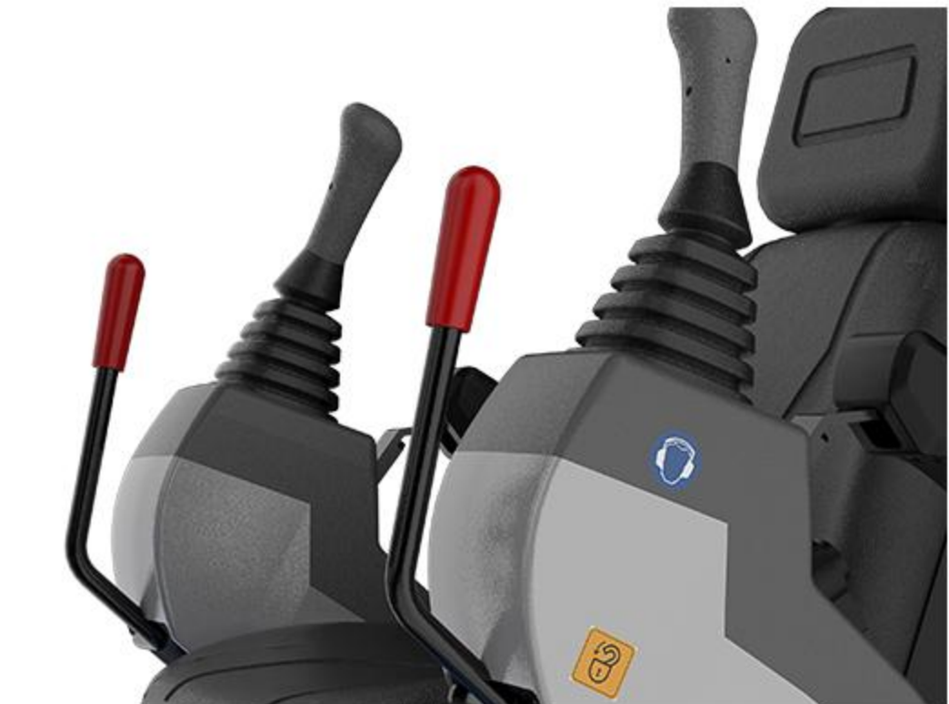
2 Betriebssperrehebel Er ist mit einer motoreutralen Startfunktion ausgestattet, die verhindert, dass der Motor startet, es sei denn, der Betriebssperrehebel ist in der erhöhten Position.
