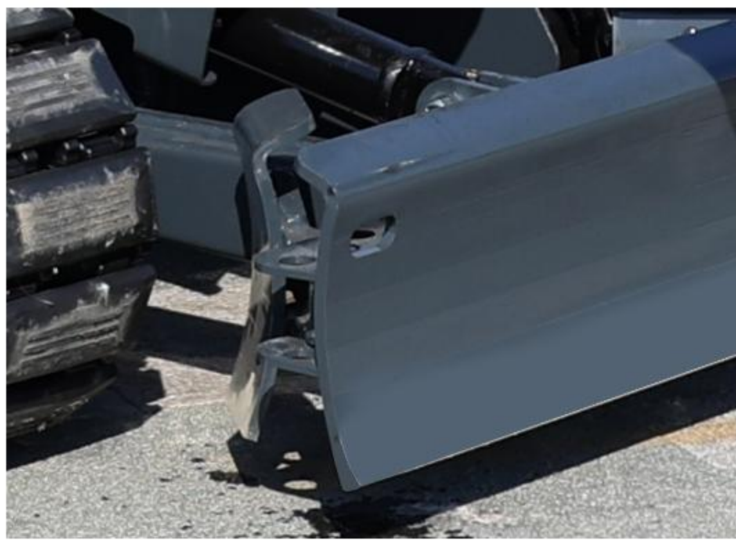
10 Erweiterte Bulldozerblatte Die Breite des Doserblatts kann durch Entfernen und Befestigen des Stiftes leicht verlängert werden.
