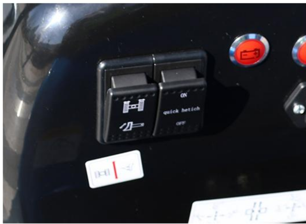
9 Multifunktions-Taste Die Schaltfunktionen der Raupenverlängerung und der Doserplatte können durch einfache Tastenbedienung sowie den schnellen Wechsel von Anhängern realisiert werden.
