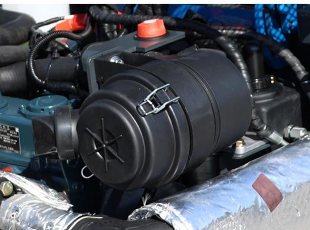
7 Luftfilter Verhindern Sie, dass Staub und Verunreinigungen in das Luftansaugsystem des Motors gelangen, wodurch die Lebensdauer des Motors verlängert wird.
