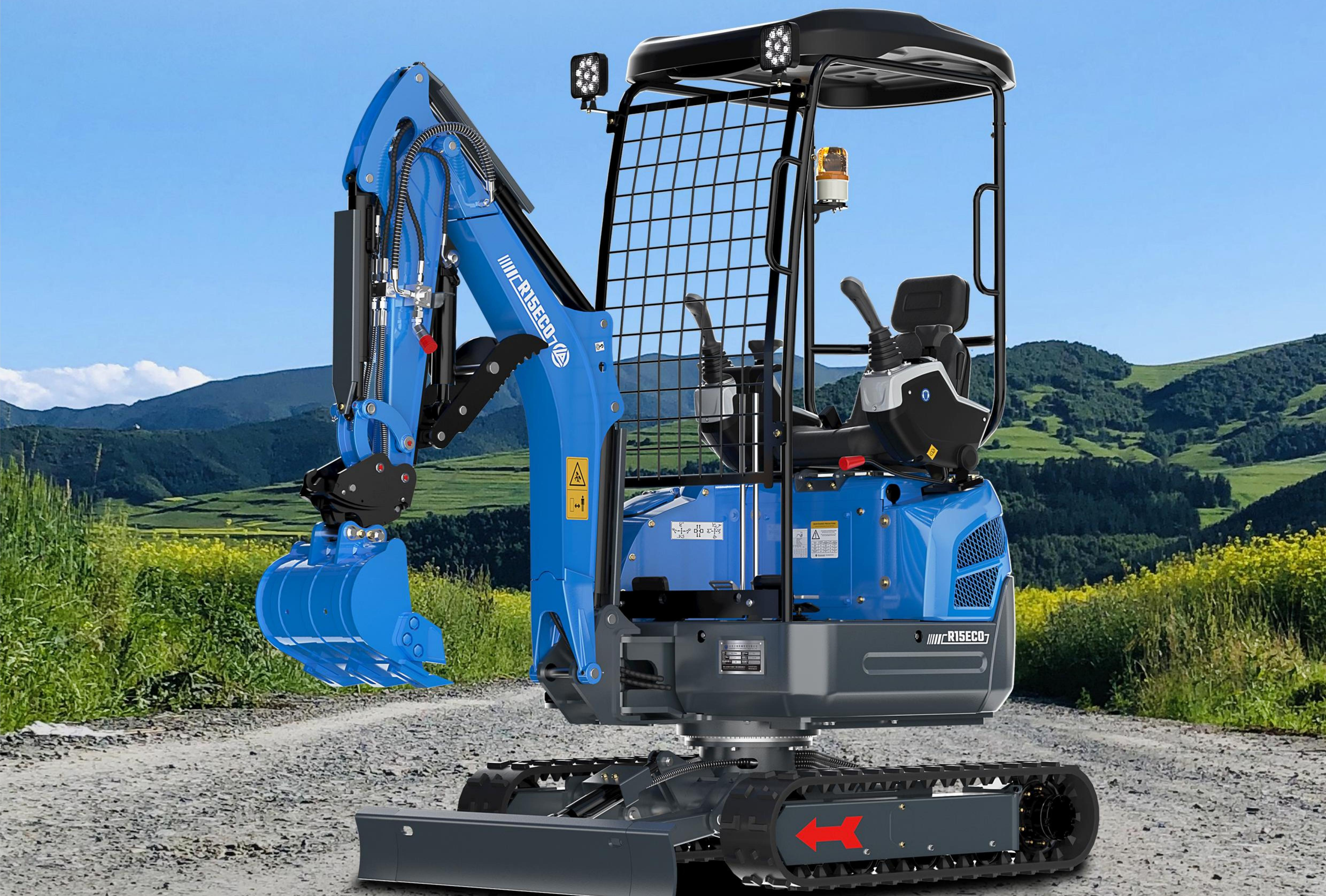
Hinweis: Die in der Abbildung dargestellte hydraulische Daumenklemmung und der hydraulische Schnellwechsel sind optionale Modelle. Das Standardmodell verfügt nicht über eine hydraulische Daumenklemmung und einen hydraulischen Schnellwechsel.
