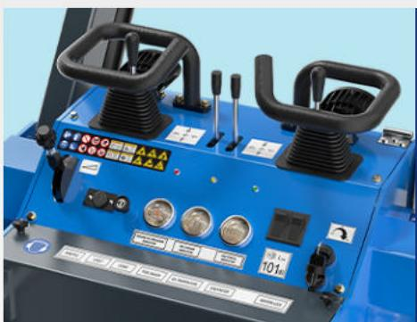
» Das Bedienfeld zeichnet sich durch ein komfortables und effizientes Design aus und ist mit zwei Handhebeln sowie unabhängigen Hebeln zur Steuerung der Anbauteile ausgestattet.
