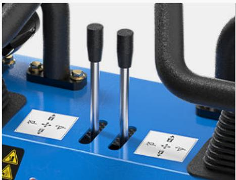
» Der Bedienhebel für Anbaugeräte ermöglicht eine präzise hydraulische Steuerung und somit einen effizienten und flexiblen Betrieb verschiedener Anbaugeräte.
