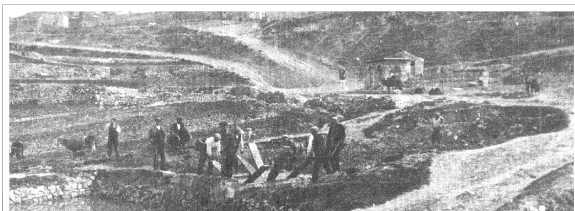
Figura 2. Los “batidores” y “pisadores” del barro, trabajando en el “Jaraíz de los Huertos” (actualmente desaparecido) a principios del siglo XX.
