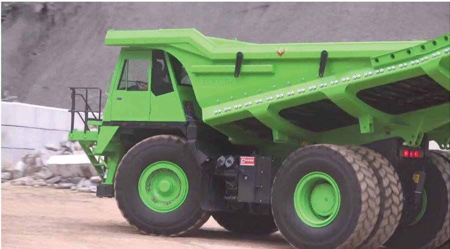
Der Trick: Er fährt in diesem Fall regelmäßig und vollbeladen abwärts und gewinnt durch das höhere Gewicht mehr Bremsenergie zurück, als er beim Hochfahren ohne Ladung benötigt. Es ist sogar noch Energie übrig, die ins Netz eingespeist wird.
