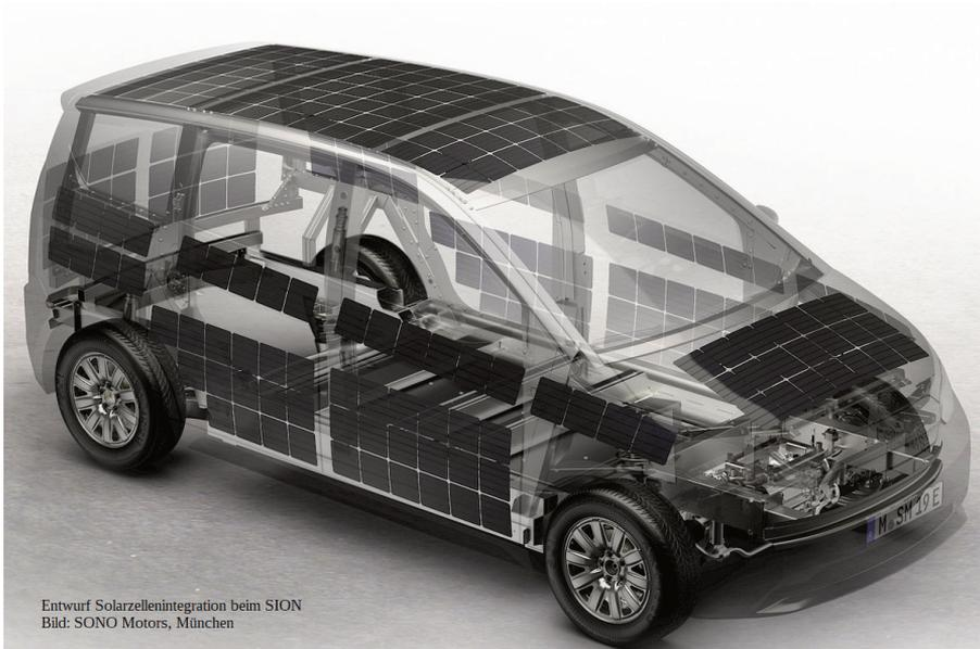
Entwurf Solarzellenintegration beim SION
