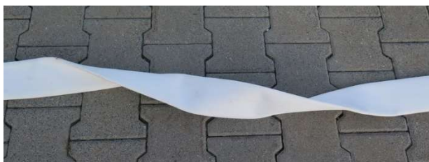
Ganze Schlauchverdrehung -> Fehlerpunkte
