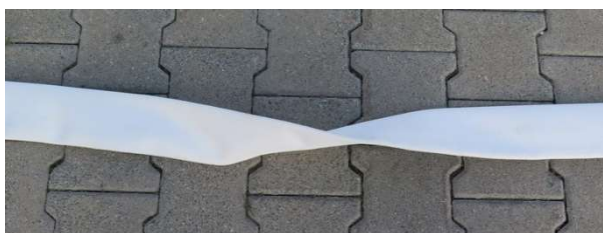
Halbe Schlauchverdrehung -> keine Fehlerpunkte
