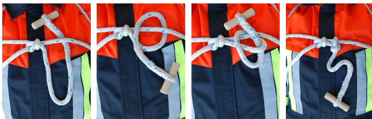
... mit Sicherung durch Spierenstich nach FwDV 1
