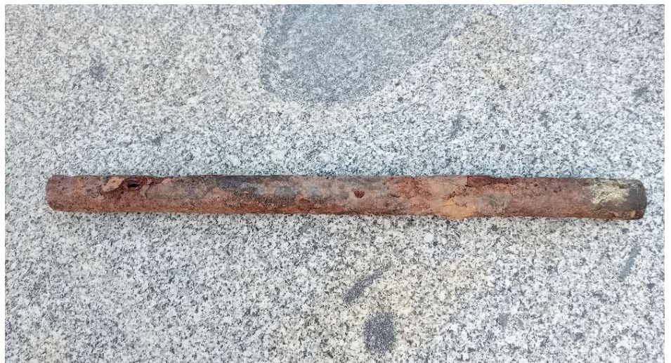
Abbildung 2, Foto, ein Stück alte Wasserleitung von 1926
