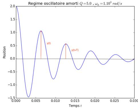
Figure 2 – Oscillations pseudo-périodiques : le décrément logarithmique est  $\delta = \ln(y(t)/y(t+T))$ .
