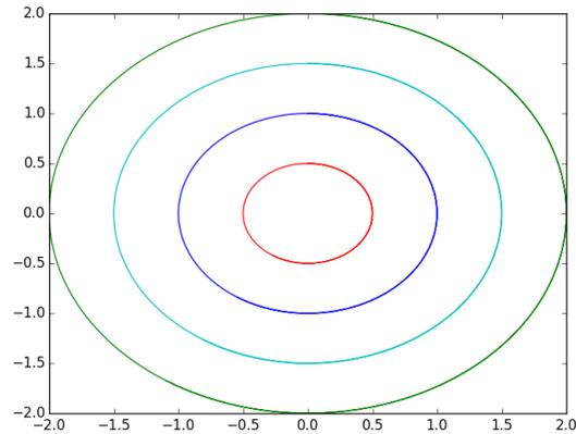
Figure 5 – Portrait de phase d'un oscillateur harmonique pour différentes conditions initiales.
