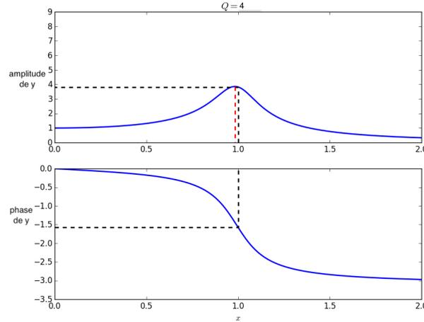
Figure 3 – Résonance en amplitude : amplitude de  $y$  et déphasage par rapport à l'excitation en fonction de  $x = \omega/\omega_0$ .
