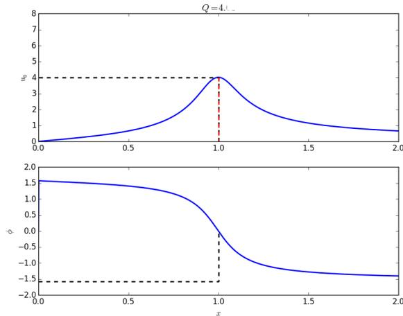
Figure 4 – Résonance en vitesse : amplitude de  $v = \dot{y}$  et déphasage par rapport à l’excitation en fonction de  $x = \omega/\omega_0$ .
