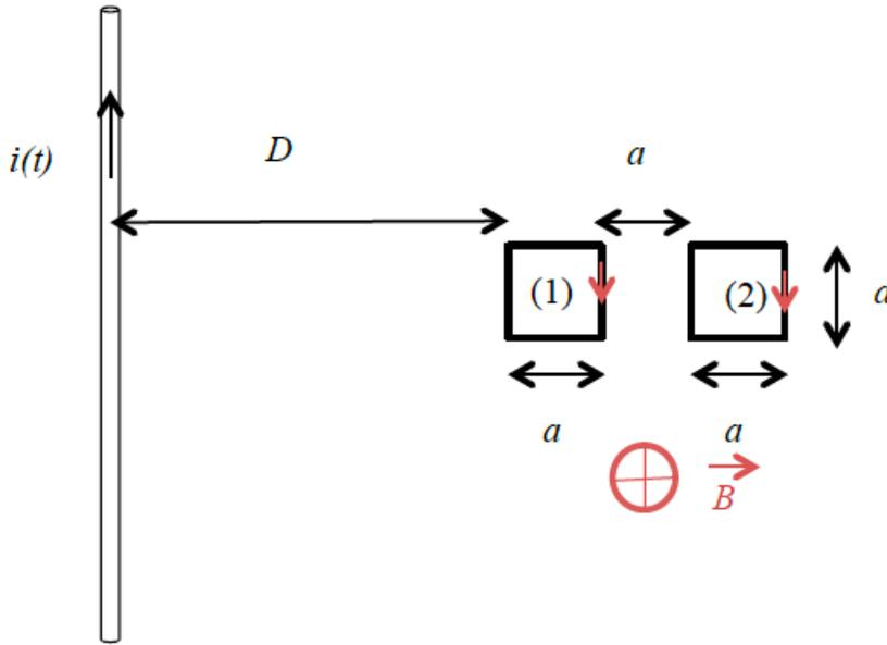
Pour évaluer le flux de  $\vec{B}$  à travers les bobines plates, il faut les orienter. L'orientation choisie ici est indiquée sur le schéma (vecteur surface selon  $\vec{u}_\theta$ ).
