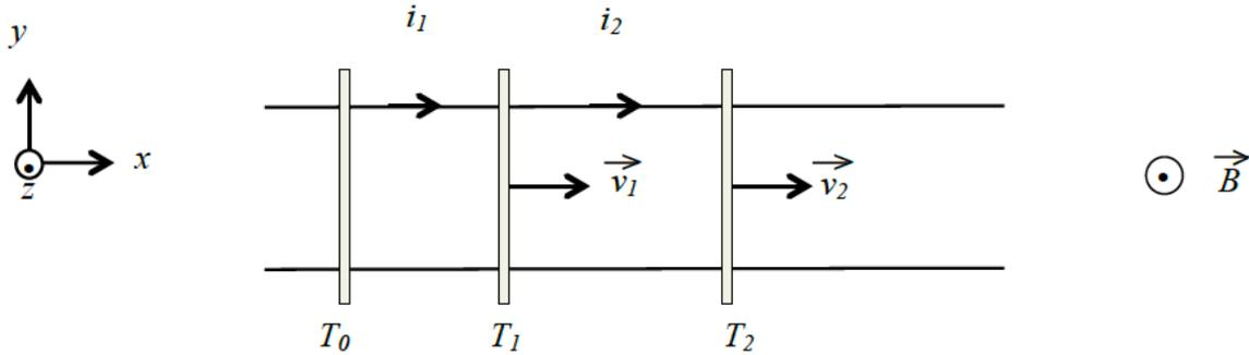
1. Dans le cas  $n = 1$ , démontrer que la force électromotrice induite dans le circuit est  $e_1 = Bav_1$ .
