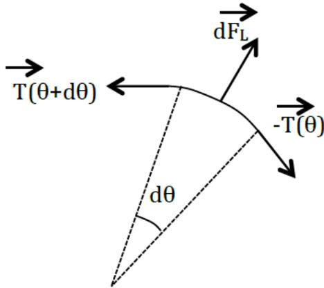
En projetant parallèlement à  $d\vec{F}_L$  :  $iBd\ell = T(\theta + d\theta) \sin\left(\frac{d\theta}{2}\right) + T(\theta) \sin\left(\frac{d\theta}{2}\right)$ .
