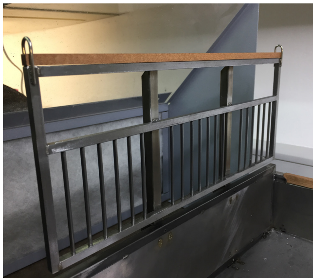
Rohbau Rückwandschutz, fertig verschweißt...
