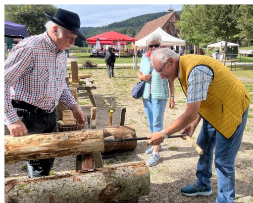
Unter Rolf Weins Aufsicht versucht ein Gast, eine Teuchel zu bohren.
