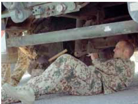
„Technische Halt“: Eine Bremse hat sich festgefahren – Stabsfeldwebel Michael K. behebt das Problem.
