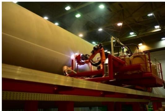
Abbildungen 4 und 5: (links) Automatisierter Spritzprozess Firma Muelhahn, (rechts) Firma Krebs (Copyright Muelhahn und Krebs)
