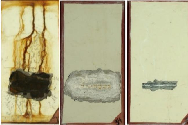
Abbildung 2 ISO 12944-9-Tests: Vergleich von Beschichtungssystemen links ohne Metallisierung, Mitte Al-Duplex, rechts ZnAl15-Duplex
