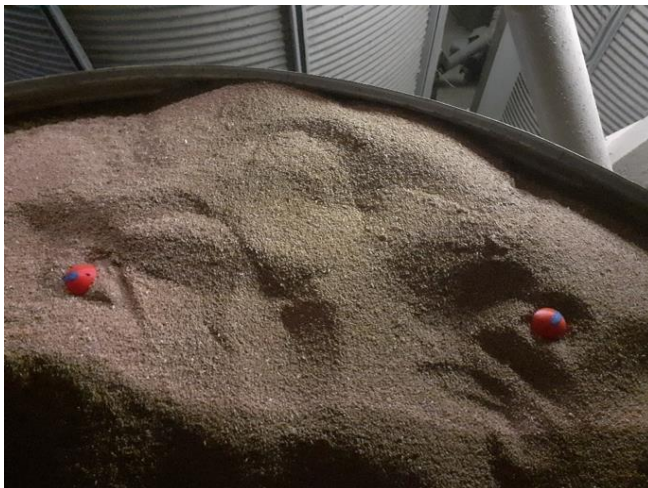
Abbildung 8: Versuchsaufbau des ersten Reichweitentests in Getreide. Das Foto links zeigt die Kugeln 2 und 3. Während des Versuchs waren die Kugeln ca. 25 cm tief im Weizen versenkt. Das Schema rechts zeigt die Anordnung der Kugeln und des Koordinators während des Versuchs.
