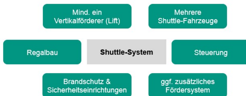
Abbildung 1: Komponenten eines Shuttle-Systems i.A. (VDI-Fachbereich Technische Logistik, 2015)
