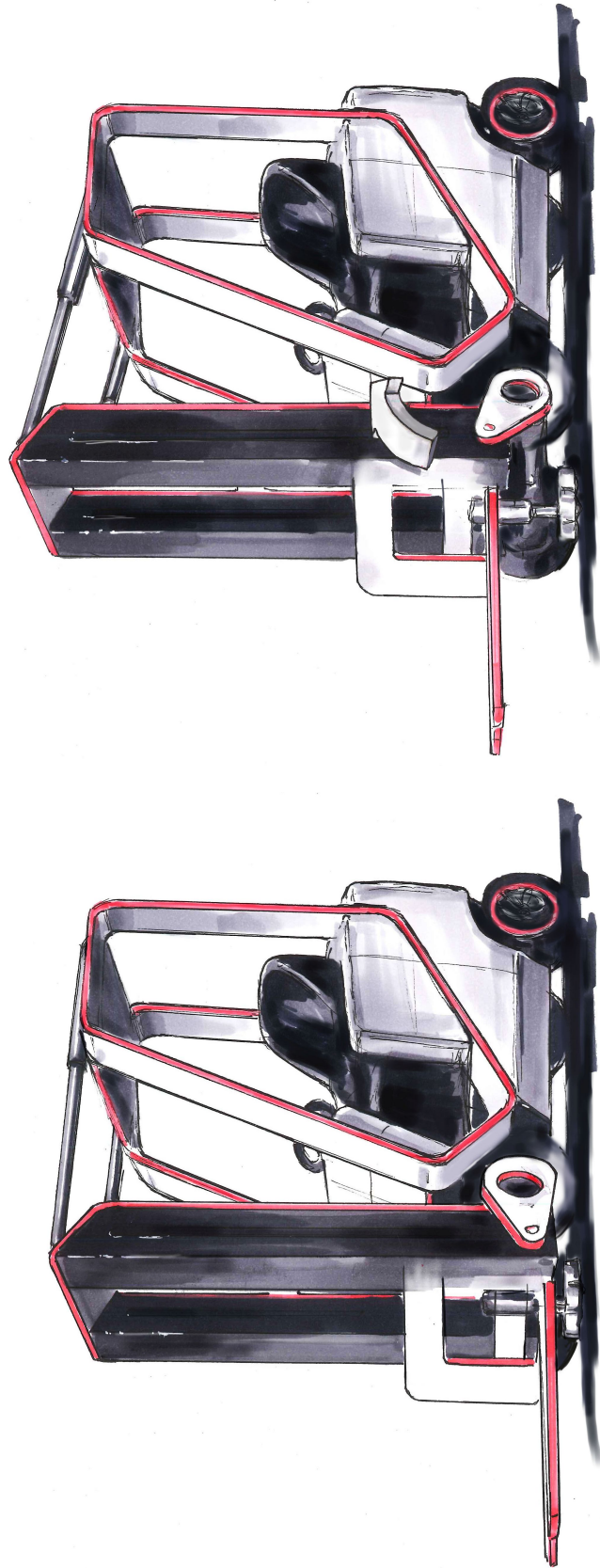
Abbildung 4.17: Konzept 5: Stapler mit einer Stütze und einem verstellbaren Hubgerüst (Illustrator: Anton Krüger)
