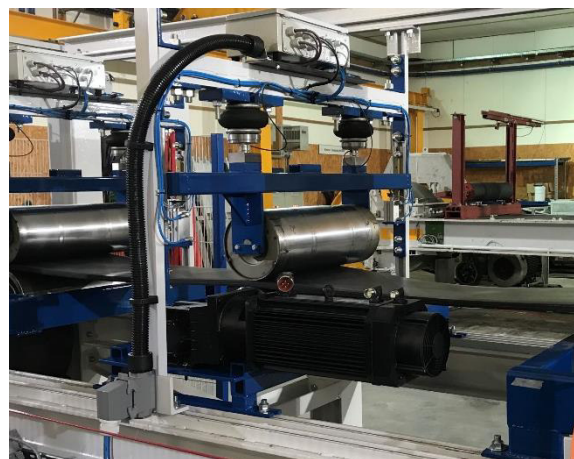
Abbildung 13: CAD-Modell angetriebene Tragrolle (links), eingebaute angetriebene Tragrolle im Prüfstand (rechts)
