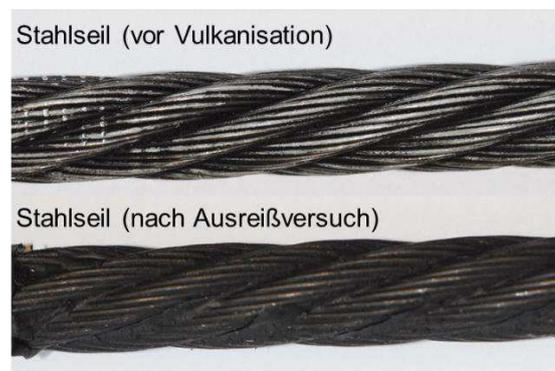
Abbildung 3-21: Stahlseil vor Vulkanisation (oben) und nach Ausreißversuch (unten)
