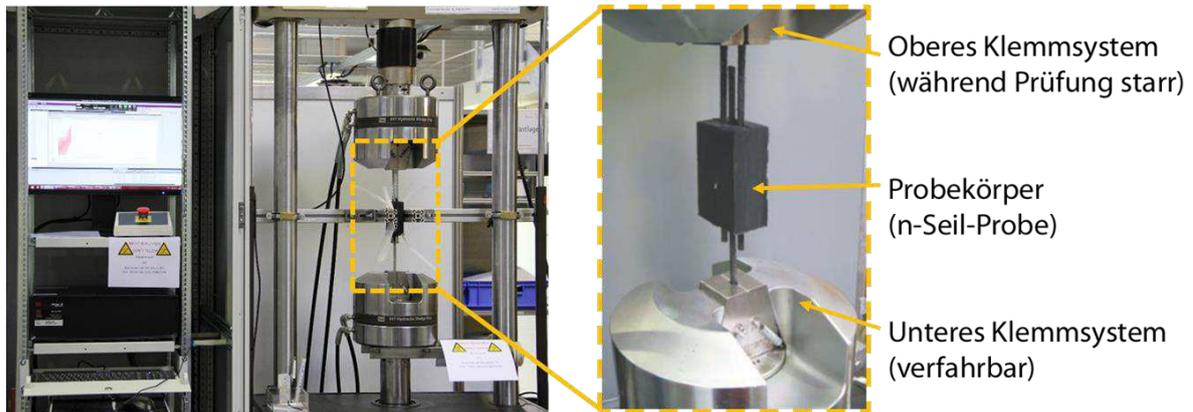
Abbildung 3-18: Zugprüfstand mit eingespannter 3-Seilprobe
