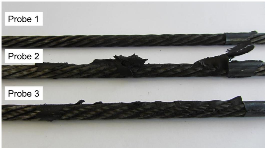
Abbildung 3-22: Ergebnisse der Ausreißversuche (2. Messreihe)
