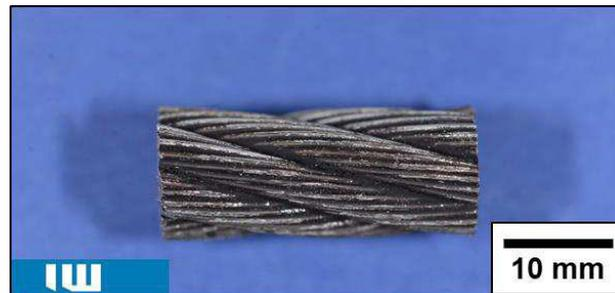
Abbildung 3-7: Mittels Modellparameter und Reinwasserflachstrahlbearbeitung freigelegtes Stahlseil
