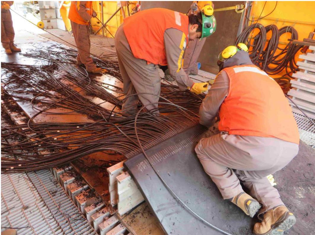
Abbildung 2-1: Verbindungsvorbereitung eines Stahlseil-Fördergurtes [Quelle: ContiTech]
