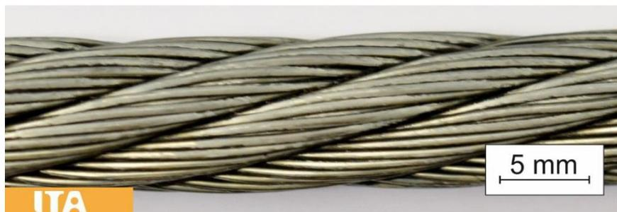
Abbildung 3-19: Mittels Wasserstrahl freigelegtes blankes Stahlseil
