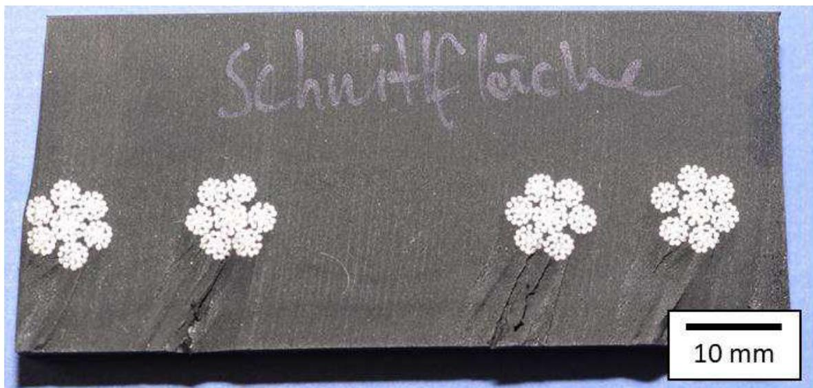
Abbildung 3-3: Schnittfläche eines WAIS Schnitts eines Stahlseilfördergurts
