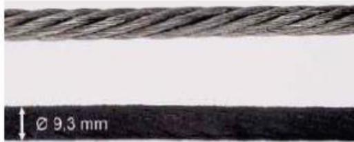
Abbildung 5: Bearbeitete Stahlseile (oben: komplett freigelegt; unten: mit ca. 0,5 mm Restgummischicht)
