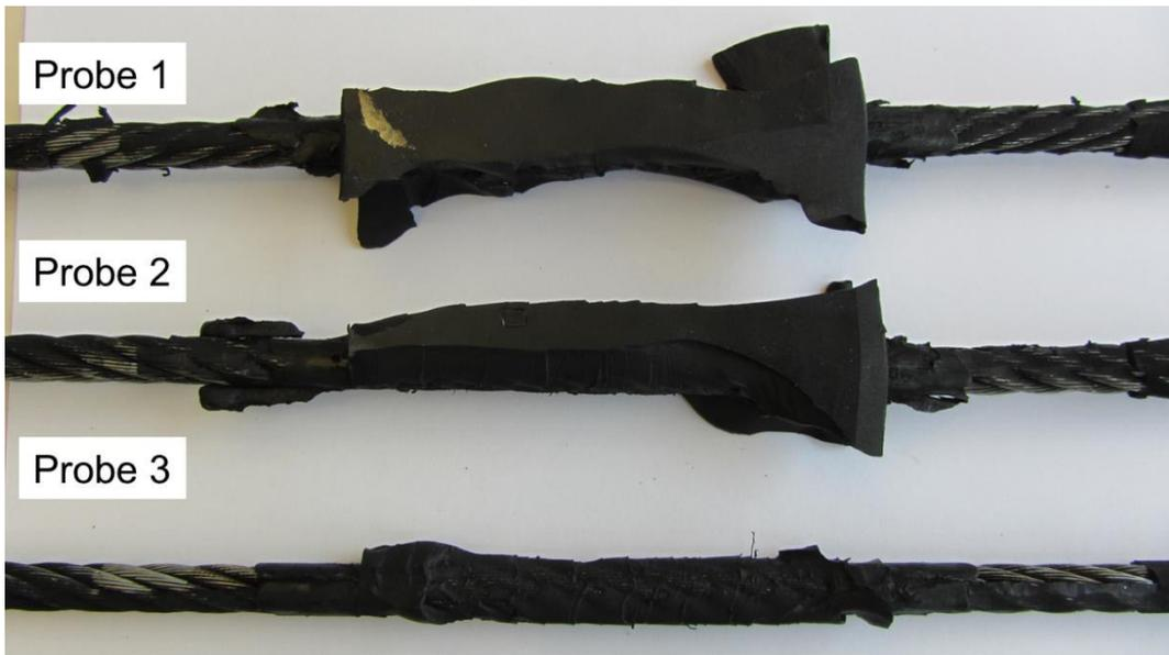
Abbildung 3-25: Ergebnisse der Ausreißversuche (Restgummischicht)
