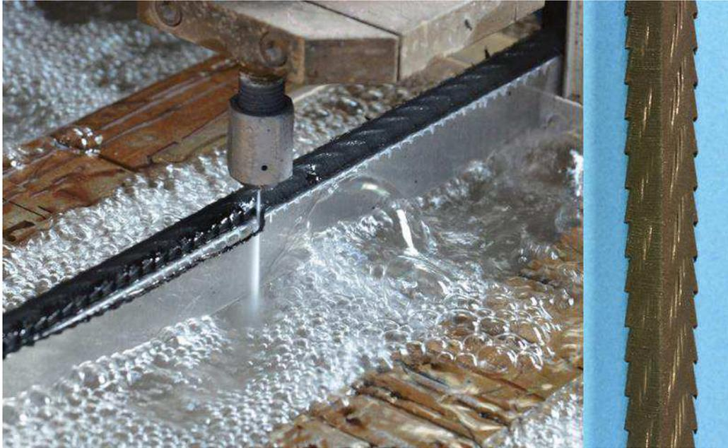
Abbildung 3-26: RWS-Schnitt zur Flankenbearbeitung (links) und Stahlseil mit strukturierter Restgummischicht (rechts)
