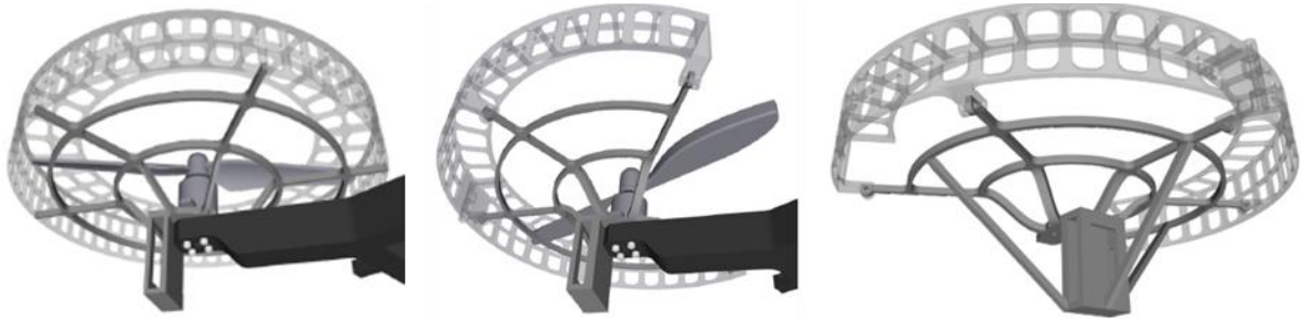
Abbildung 24: CAD-Modelle der konzipierten und untersuchten Propellerschutzkäfige
