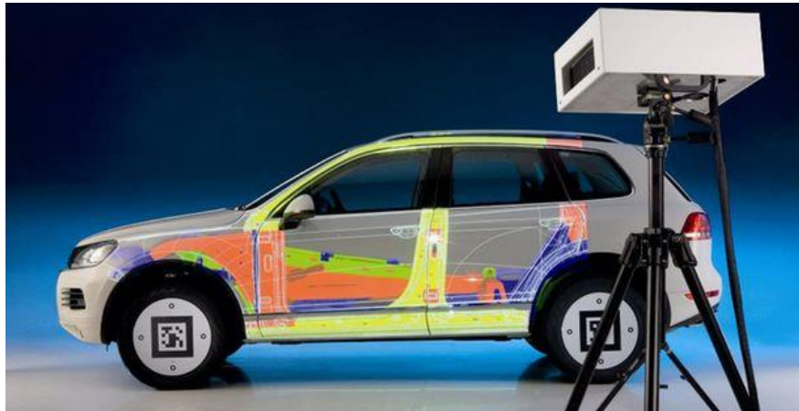
Abbildung 5-2: Projection Mapping (Quelle: Volkswagen)
