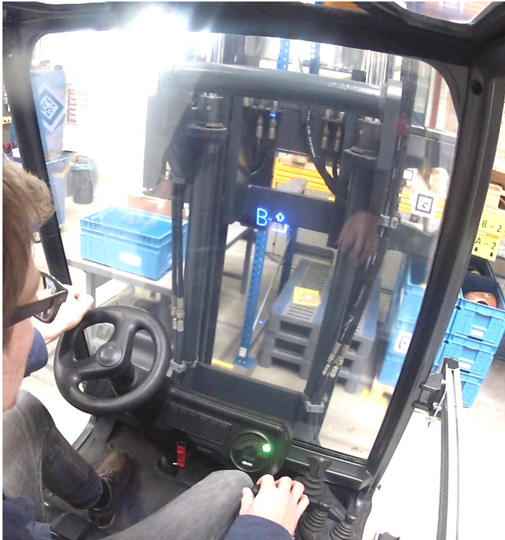
Abbildung 7-8: Durch eine Darstellung der korrekten Regalebene (B) des anzufahrenden Lagerplatzes und eines Pfeils wird der Fahrer beim Einstellen der Hubhöhe unterstützt
