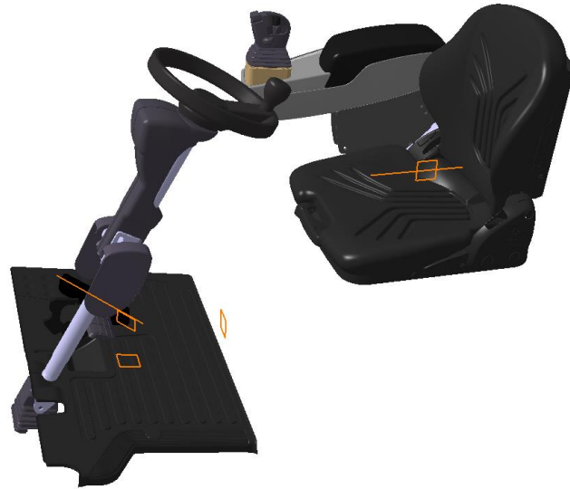
Abbildung 6-5: Positionierung des Manikins anhand definierter Körperpunkte
