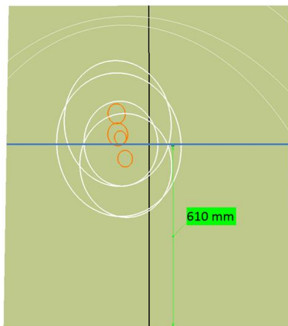
Abbildung 6-8: Vertikale Anzeigehöhe (Unterkante) bei Fokussierung auf den Mittelpunkt zwischen den beiden Gabeln, wobei sich die Gabel auf Höhe des Regalfach 1 befindet; orange definiert die fovealen Sichtbereiche und weiß die parafovealen Sichtbereiche für die vier Extremanthropometrien
