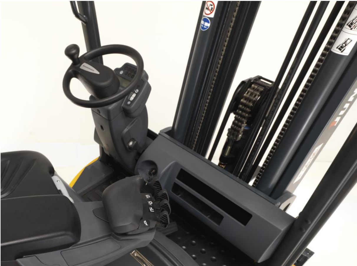
Abbildung 3-7: Anzeigeeinheit hinter dem Lenkrad (Quelle: Jungheinrich AG)
