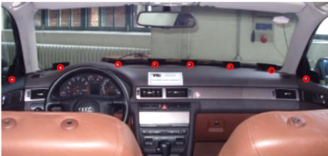
Abbildung 4-4: LED-Anzeige in der Scheibenwurzel (Quelle: [Küh-2003])
