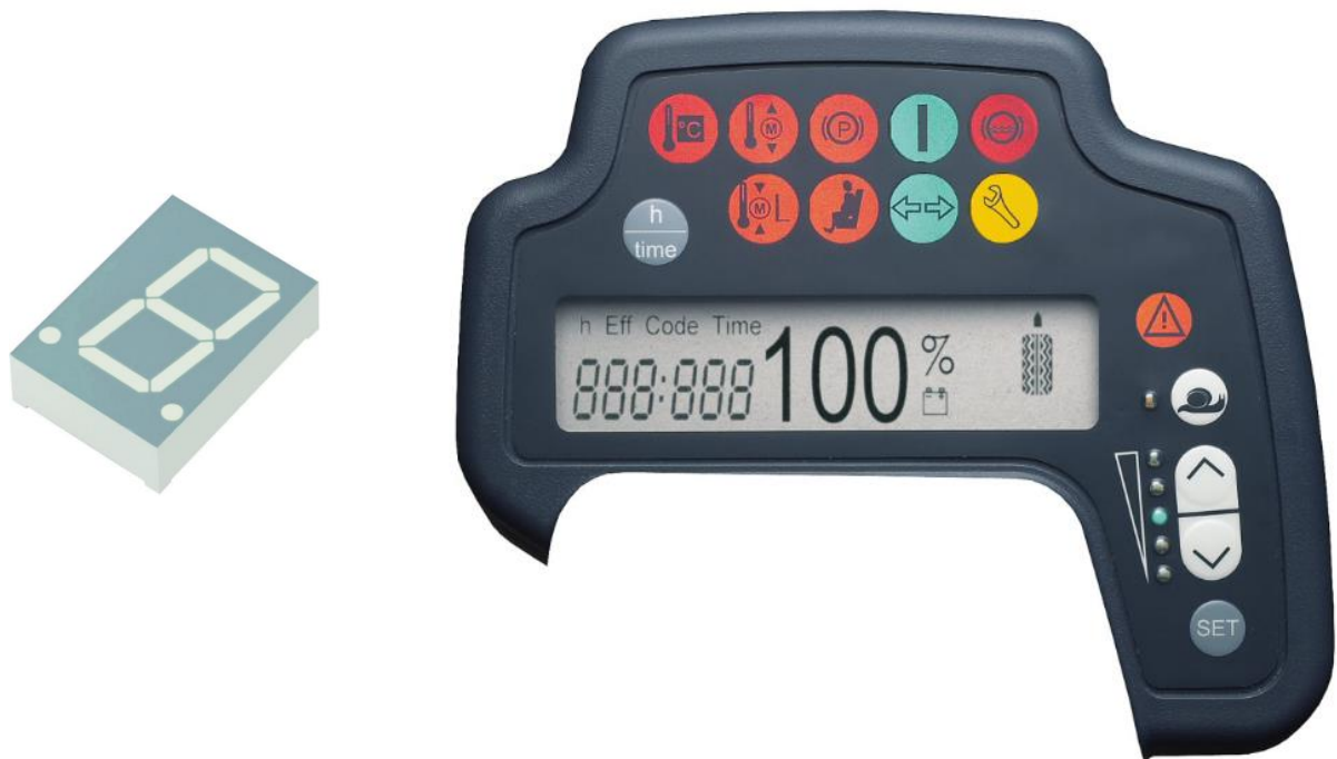
Abbildung 3-6: links: Segmentanzeige rechts: Anzeigeeinheit eines Gabelstaplers (Quelle: Jungheinrich AG)
