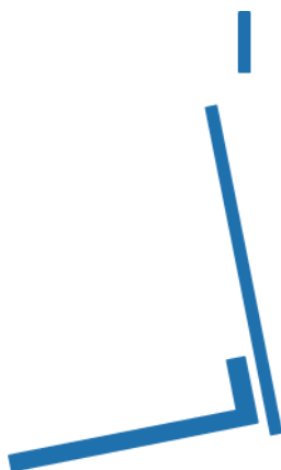
Abbildung 6-13: Mast muss zurückgeneigt werden, um in Senkrechtstellung zu gelangen. Entsprechende Anzeige in entgegengesetzter Richtung möglich.
