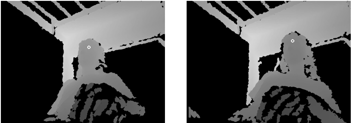
Abbildung 5-6: Tiefenbild der Kinect in einer Gabelstaplerkabine
