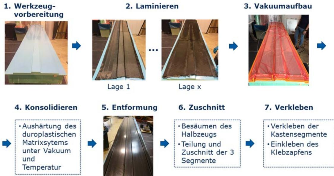
Abbildung 28: Ablauf der Fertigung des CFK-Demonstratormasts
