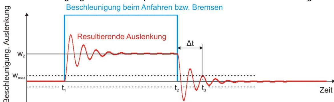
Abbildung 11: Schematische Darstellung des Schwingungsverhaltens beim Anfahren und Abbremsen eines RBG
