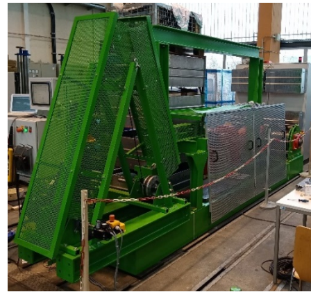
Abbildung 9: Prüfstand für Spulversuche, a) schematischer Aufbau, b) realer Prüfstand
