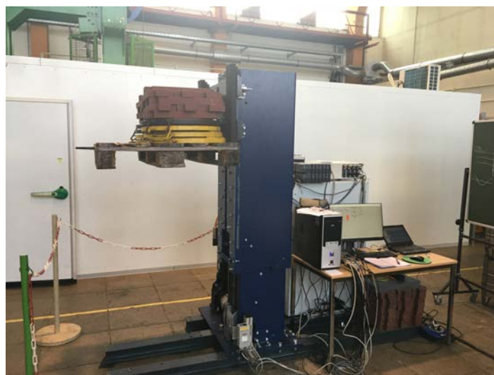
Abbildung 12: Hubgerüst-Prüfstand in Vorder- und Seitenansicht mit 1000 kg Nutzmasse
