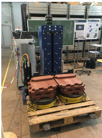
Abbildung 12: Hubgerüst-Prüfstand in Vorder- und Seitenansicht mit 1000 kg Nutzmasse
