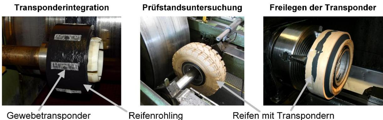
**Abbildung 4-5: Integration, Belastung und Freilegung der Transponder**
