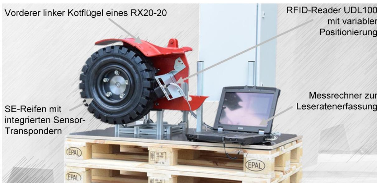
**Abbildung 4-30: Prüfstand für die Untersuchung der erreichbaren Leserate mit einem Sensortransponder und einem am Fahrzeugmodell verbauten RFID-Reader**
