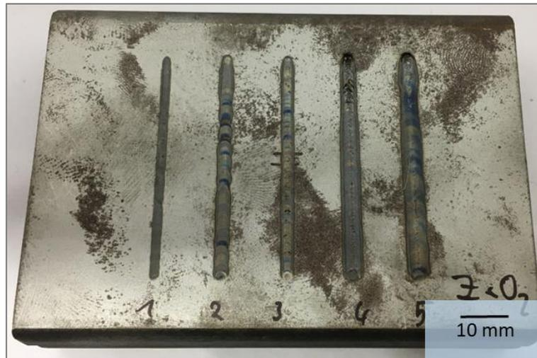
Abbildung 18: Beispielprobe mit fünf unterschiedlichen Lasermarkierungen zur Bestimmung der Eignung der unterschiedlichen Wirbelstromsensortypen; als Zusatzmaterial wurde Zirkoniumoxid verwendet
