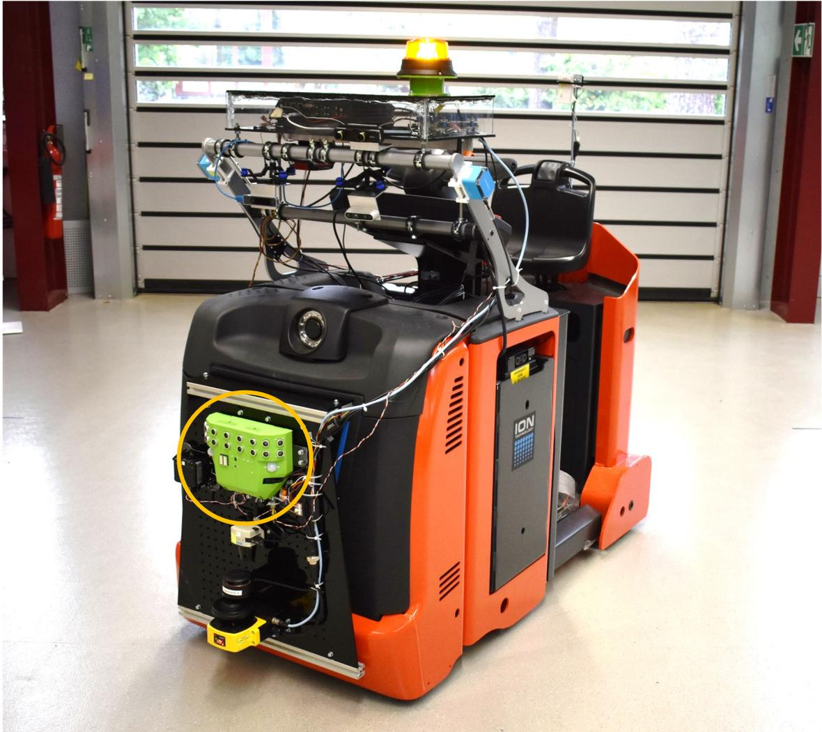
Abbildung 39: Sensorbox für die Fusion unterschiedlicher Sensoren im Kontext der IEC TS 62998 (oranger Kreis)
