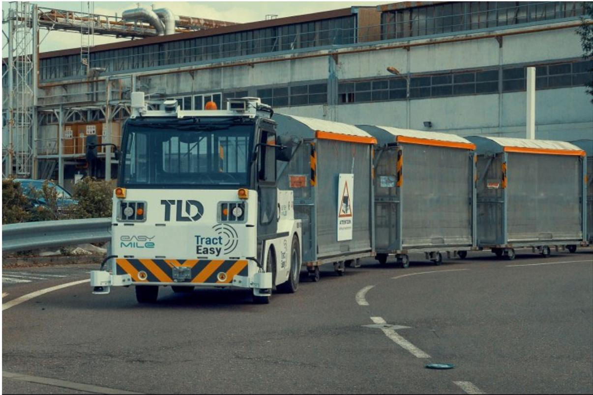
Abbildung 5: Der fahrerlose Schlepper TractEasy der Firma EasyMile [50]
