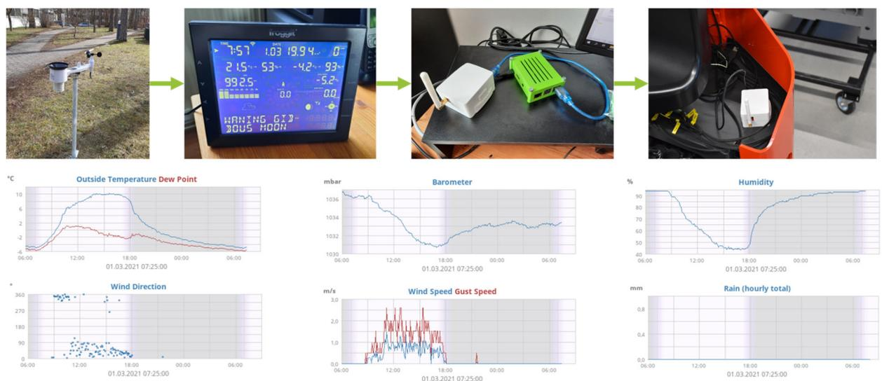
Abbildung 54: Kommunikationskette für die Mitteilung externer Wetterparameter an den fahrerlosen Routenzug zur Definition der Umgebungseinflüsse
