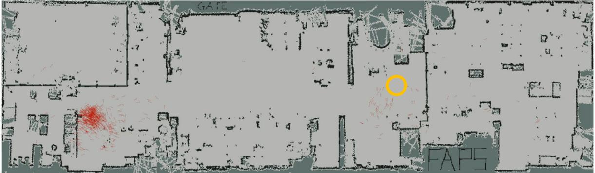
Abbildung 27: Kovarianz der Ortung mit AMCL für  $t = 13$  s mit tatsächlicher Pose des Labordemonstrators (oran-ger Kreis)
