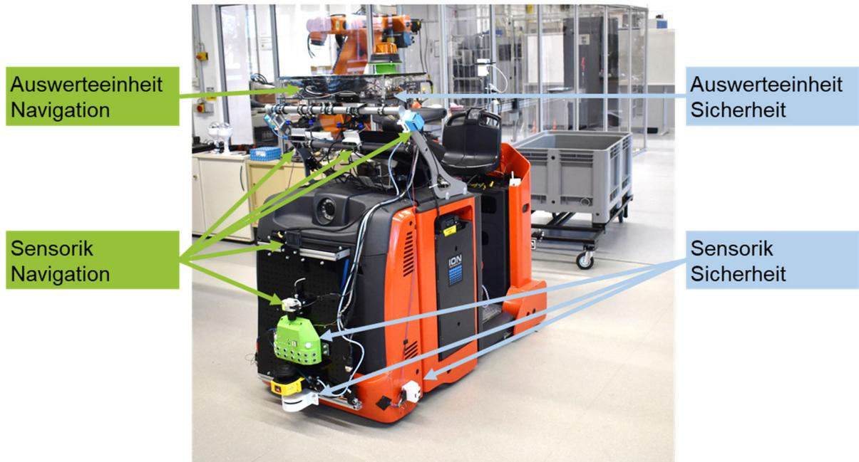
Abbildung 41: Zusammenführung des Konzeptes der vollständigen Digitalisierung der Einsatzumgebung sowie der Sensoren für die übergangslose Ortung und Navigation und der potentiell sicheren Sensorik
