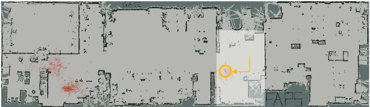
Abbildung 28: Kovarianz der Ortung mit AMCL für  $t = 32$  s mit tatsächlicher Pose des Labordemonstrators (oran-ger Kreis) sowie dem Sektor der Bewegung (hellgraues Rechteck)
