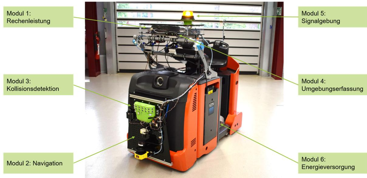
Abbildung 49: Module für den übergangslosen Betrieb eines fahrerlosen Schleppers bei Mischverkehr
