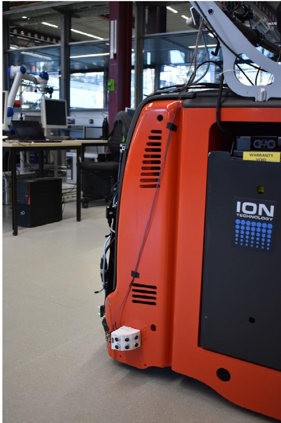
Abbildung 46: Exemplarische Darstellung der Sensorik zur rotatorischen Absicherung mittels kosteneffizienter Sensoren
