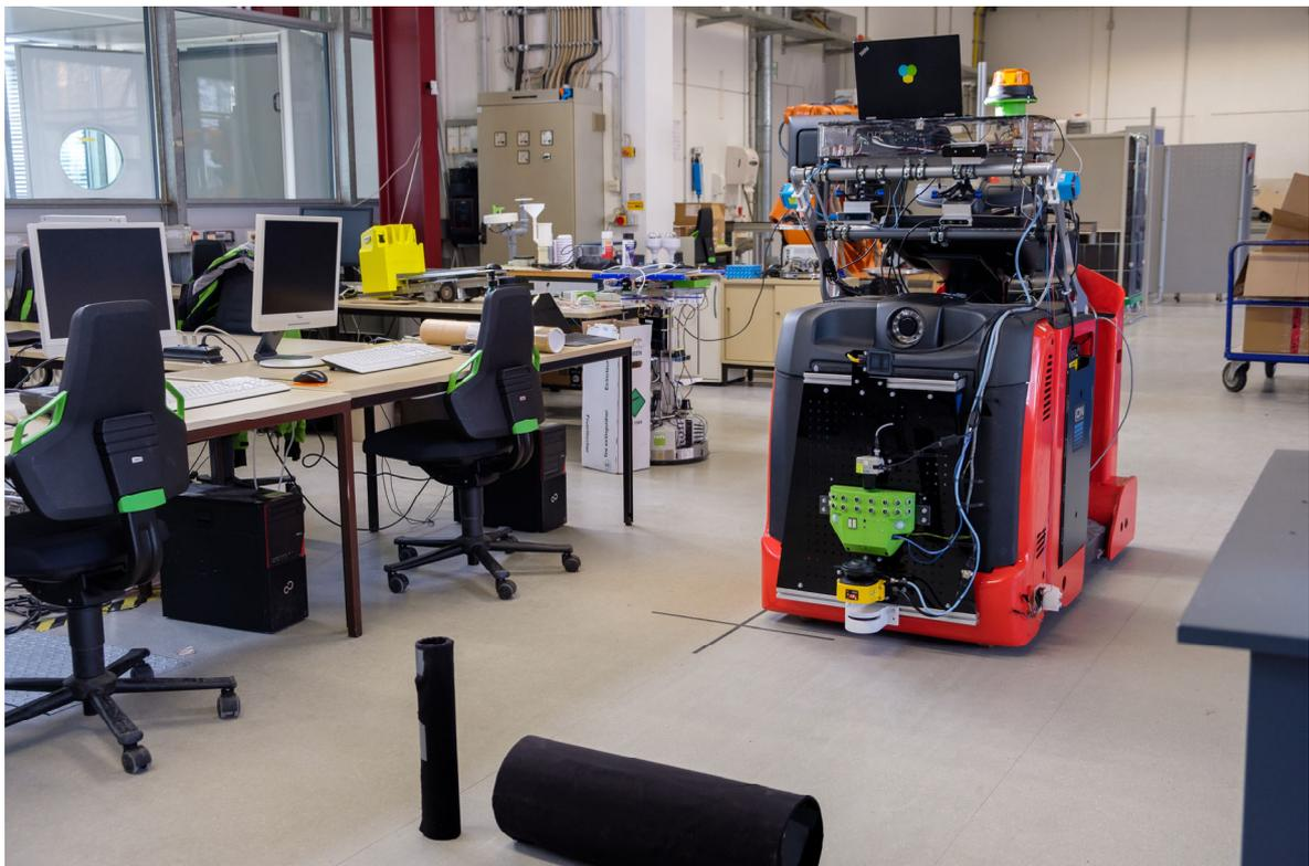
Abbildung 45: Durchführung der Prüfungen gemäß der EN ISO 3691-4 am Lehrstuhl für Fertigungsautomatisierung und Produktionssystematik in Erlangen
