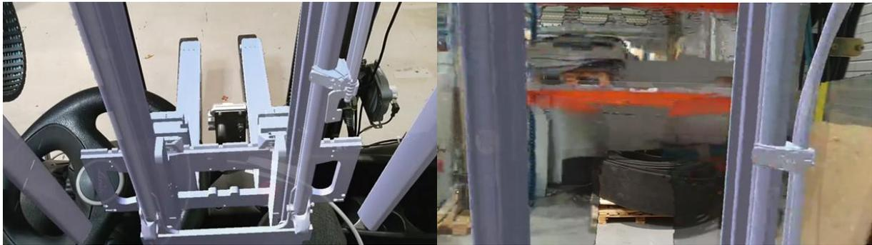
Abbildung 2-15: Einblendung der Staplergeometrie (links), Einblendung von Staplergeometrie und kompletten Punktwolken (rechts)
