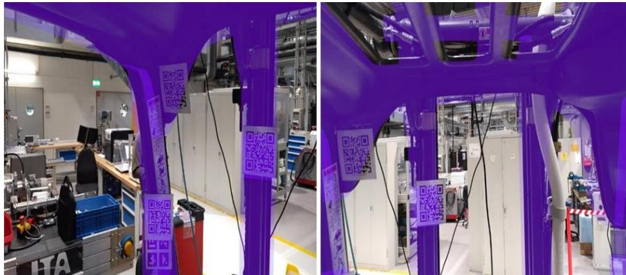
Abbildung 2-13: Markerbasierte Sichteinschränkungsdetektion mit Einblendung auf der HoloLens 2
