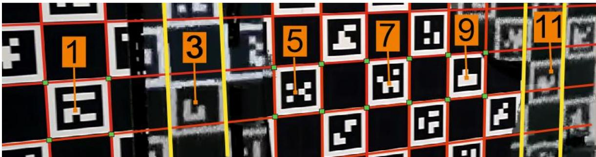
Abbildung 2-33: Interpolierte Kanten des Schachbretts (gelb)
