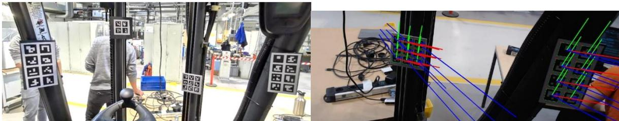
Abbildung 2-17: Anbringung ArUco-Marker im Gabelstapler (links), Detektion der Marker (rechts)
