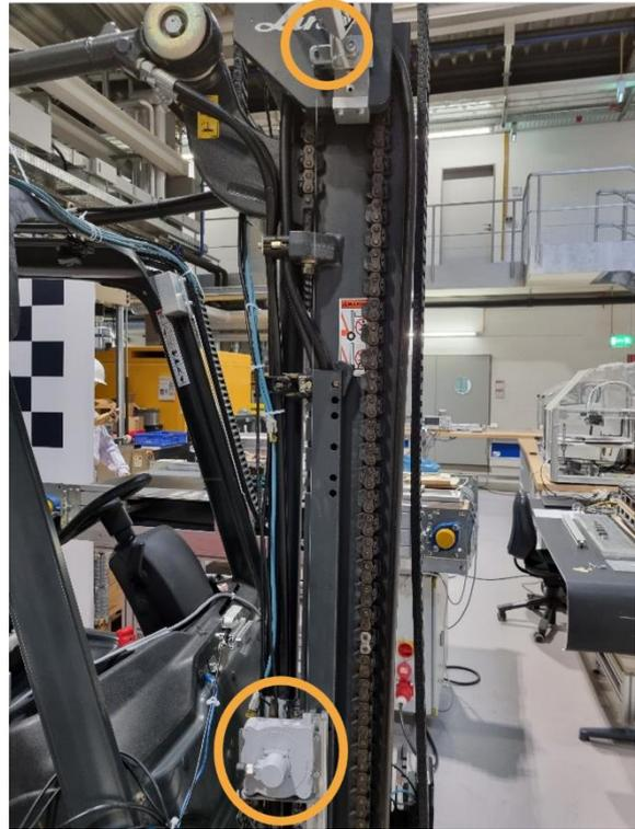
Abbildung 2-19: Anbringung der Trackingkamera am Gabelträger (links), Anbringung des Seilzugsensors am Hubmast (rechts)
