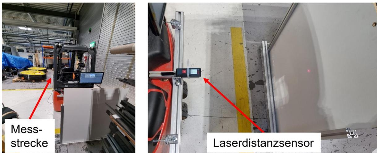
Abbildung 2-25: Messaufbau zur Bestimmung der Abweichung zwischen Realität, Tracking der HoloLens 2 und Drehgeber-Skript
