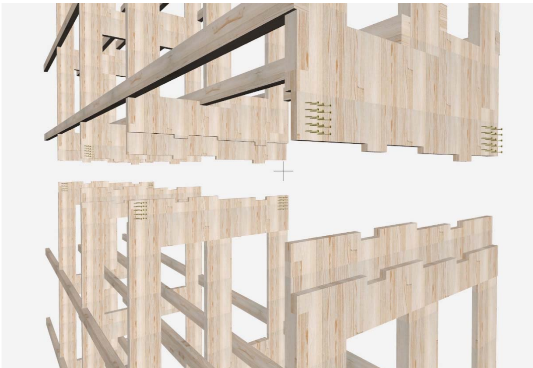
Abbildung 72: Darstellung eines beispielhaften Steherstoßes
