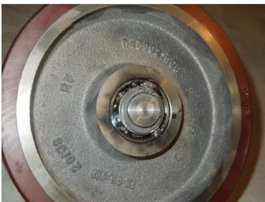
Abbildung 16: Durch Schweißpunkte blockierte Führungsrolle
