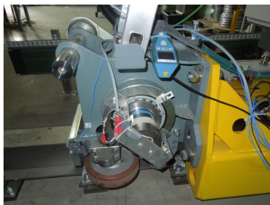
Abbildung 12: links: Labor-Messsystem montiert auf dem Podest oberhalb des Schaltschranks; rechts: Labor-Sensorik zur Erfassung der Antriebsdrehzahl
