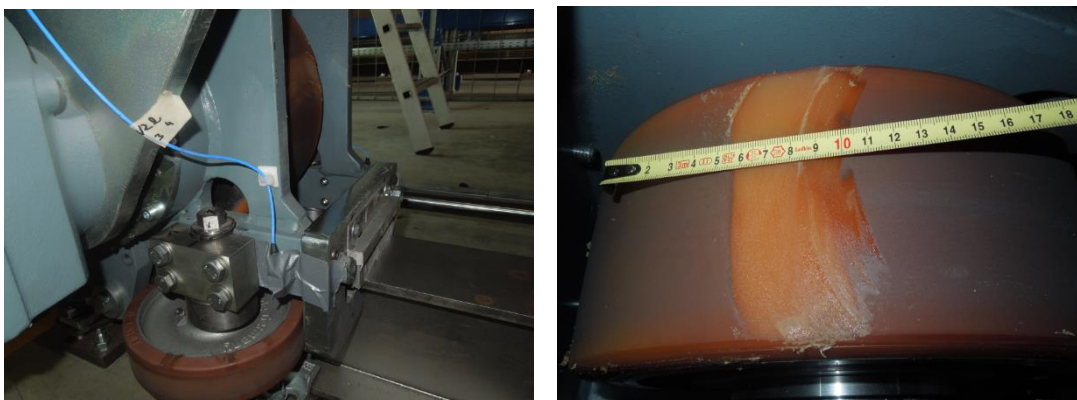
Abbildung 14: Durch Bearbeitung mit einer Schleifscheibe abgeplattetes Antriebsrad
