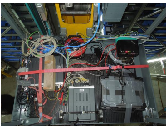
Abbildung 12: links: Labor-Messsystem montiert auf dem Podest oberhalb des Schaltschranks; rechts: Labor-Sensorik zur Erfassung der Antriebsdrehzahl
