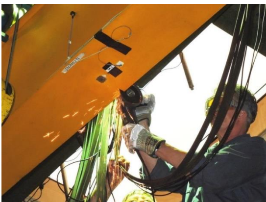
Abbildung 25: Einbringen der beiden Schäden am Untergurt in der Mitte eines Katzträgers. Die Schädigung 1 befindet sich auf der Außenseite des Krans. Die Schädigung 2 auf der Innenseite.
