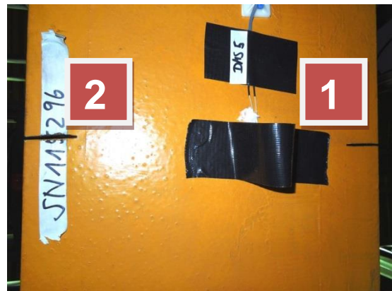
Abbildung 25: Einbringen der beiden Schäden am Untergurt in der Mitte eines Katzträgers. Die Schädigung 1 befindet sich auf der Außenseite des Krans. Die Schädigung 2 auf der Innenseite.
