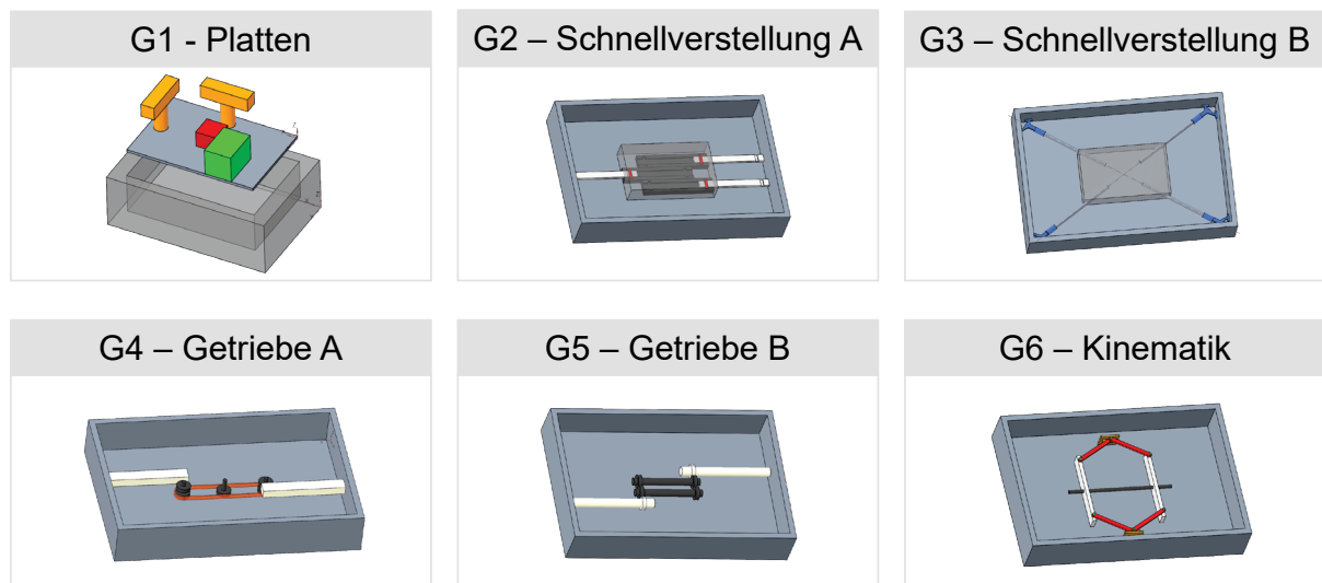
Abbildung 5-22: Grobkonzepte für die Grundgestelle der Erfassungseinheit nach den Vorgaben der Anpassbarkeit und Zentrierung
