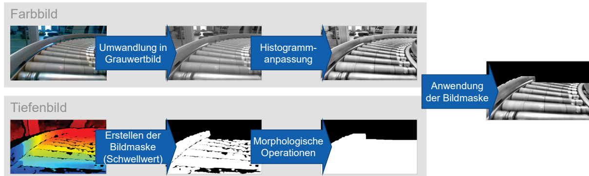
Abbildung 6-22: Schritte der Bildverarbeitung anhand eines Beispielbilds (Rollenband - Kurve)
