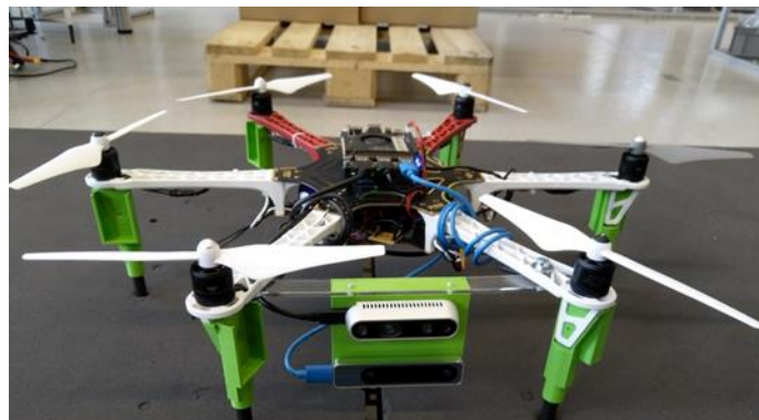
Abbildung 16: Multicopter mit D435-Kamera (oben) und T265-Kamera (unten)
