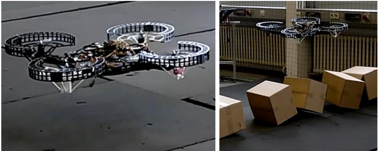
Abbildung 12: Quadrocopter basierend auf dem 3D-gedruckten Rahmen im Flug
