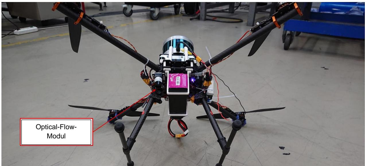
**Bild 6: Das Optical-Flow-Modul des MKS für den Einsatz innerhalb von Fabrikgebäuden**
