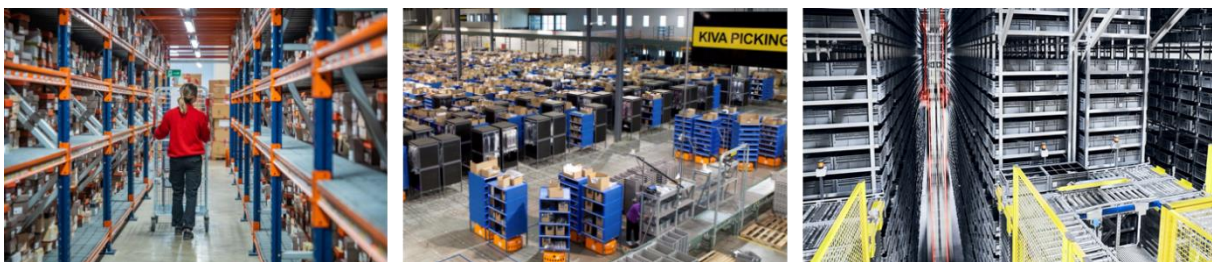
Abbildung 1: Gegenüberstellung klassischer Kommissioniersysteme (links + rechts) mit mobilen Kommissioniersystemen (Mitte)
