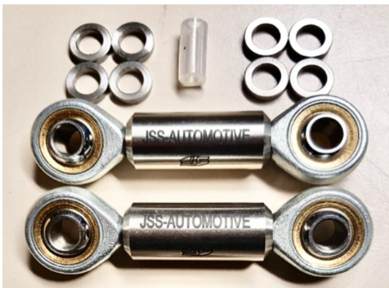
Die Koppelstangen verbinden den Stabilisator mit dem Fahrwerk des Rykers. Über sie werden die Kräfte, die vom Stabilisator aufgenommen werden, an das Fahrwerk übertragen. Serienmäßig sind diese aus Kunststoff, die sich bereits bei ca. 4.800 Newton um 2% längen. Die Strong-Link Koppelstangen lägen sich dagegen bei 14.000 Newton lediglich um 1% und sind damit 4x stärker als die Serien-Koppelstangen.
