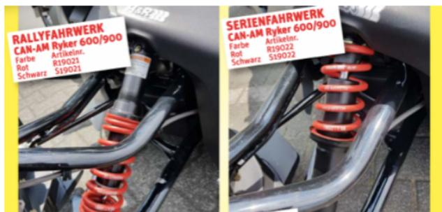
In kritischen Situationen wie z.B. plötzlichen Ausweichmanövern oder bei sportlicher Fahrweise schafft man es leicht, dass die Stoßdämpfer bis auf die Gummipuffer aufschlagen und das Fahrwerk an seine Grenzen stößt. Des Weiteren sprechen die elektronischen „Helferlein“ sehr schnell an und bremsen einen bei einer sportlichen Kurvenfahrt unvermittelt aus.
