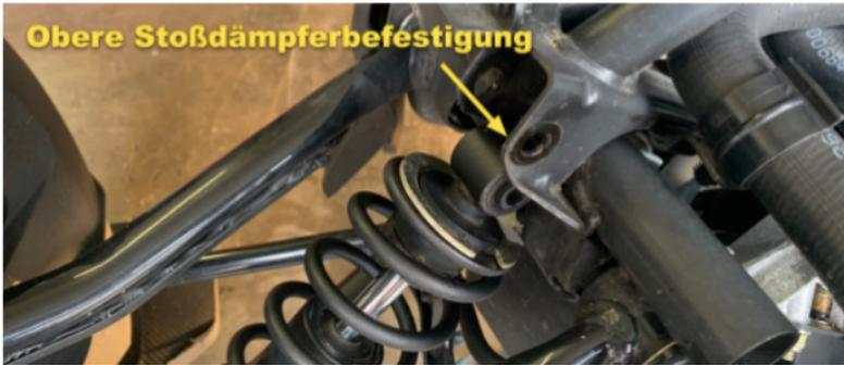
Die Stoßdämpfer werden jeweils mit einer Schraube an der Ober- und an der Unterseite befestigt. Muttern lösen und Schrauben herausziehen.
