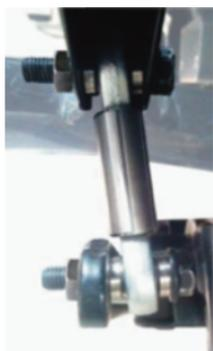
Die Koppelstangen von JSS/QRT sind optimal auf deren Sport-Stabilisator abgestimmt und können in drei Positionen am Stabi montiert werden.
