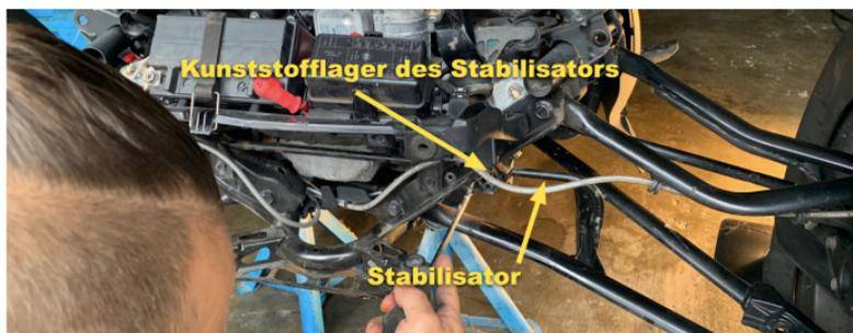
Um den Stabilisator herauszunehmen, müssen zunächst die Kunststofflager, die ihn halten, aus der Halterung geschoben werden. Sie bestehen aus zwei Hälften und können ganz einfach auseinander geklappt werden.
