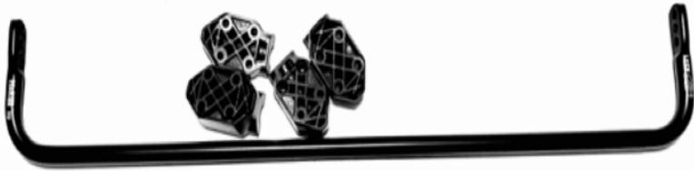
Der Grund für die starke Wankneigung von 3-rädrigen Fahrzeugen wie dem Ryker ist in der Tatsache begründet, dass lediglich nur eine breite Achse bei Kurvenfahrten die seitlich wirkenden Kräfte, welche vom Aufbau ausgehen, aufnehmen muss. Bei einem vierrädrigen Fahrzeug werden diese Kräfte auf zwei Achsen verteilt, und die Belastung pro Achse ist somit nicht so groß. Das mittig angebrachte Hinterrad kann diese Kräfte hingegen bei einer Kurvenfahrt nicht messbar reduzieren.
