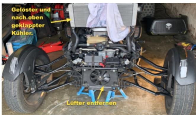
Anschließend den hinter dem Kühler befindlichen Ventilator demontieren. Nun kann man bereits die Befestigung des Serien-Stabilisators sehen und die Befestigungsschrauben der entsprechenden Kunststofflager können entfernt werden. Ebenfalls können die Koppelstangen, die jeweils an den Enden den Stabi mit den A-Arms verbinden, gelöst und entfernt werden.
