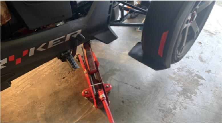
Zunächst muss der Ryker vorne aufgebockt werden. Hierfür seitlich von hinten einen Wagenheber unter den Ryker schieben, hochpumpen und den Ryker mit zwei Stellböcken aufbocken. Dabei ist darauf zu achten, dass die Vorderräder nicht mehr auf dem Boden stehen. Anschließend die Frontverkleidung abbauen.
