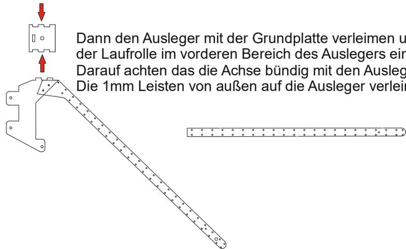
Dann den Ausleger mit der Grundplatte verleimen und die 2 mm Achse mit der Laufrolle im vorderen Bereich des Auslegers einstecken.
