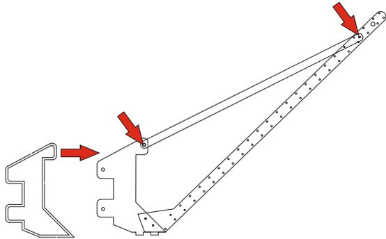
Nun die Auslegerhalterung Montieren und mit den beigelegten Nieten Fixieren und verleimen.
