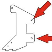
Nun die Achsen mit der 5mm Hülse einstecken und das kleine aufstecken die andere Seite der Achse bleibt bündig mit der Auslegerhalterung.
