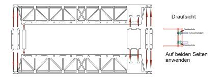
Anschließend die Achsträger und die Abstandshalter verleimen.
