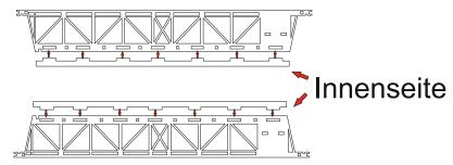
Zuerst die Laufflächen für die Laufkatze verleimen, darauf achten das sich diese auf der Innenseite befinden
