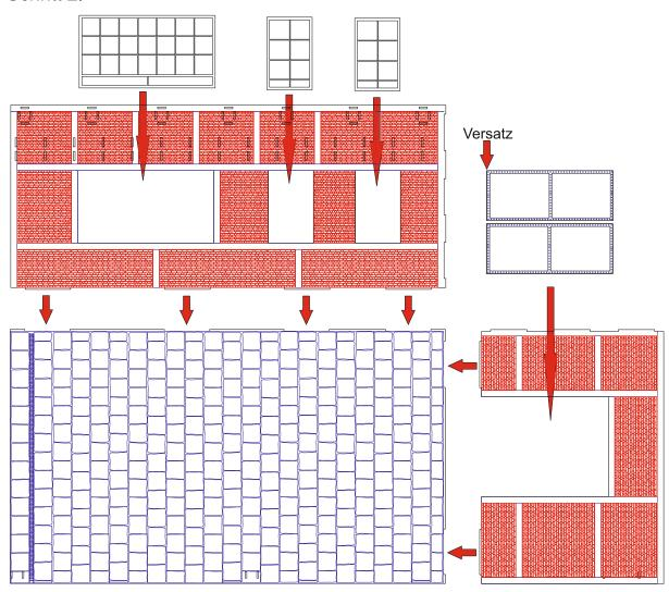
Bodenplatte mit Rückwand und Vorderwand verleimen. Zur Verwendung ist Express Holzleim zu empfehlen. Als Hilfe einen 90 Grad Anschlagwinkel nutzen um die Wände genau rechtwinkelig auszurichten. Mit Kreppband die verleimten Wände in Position halten.
